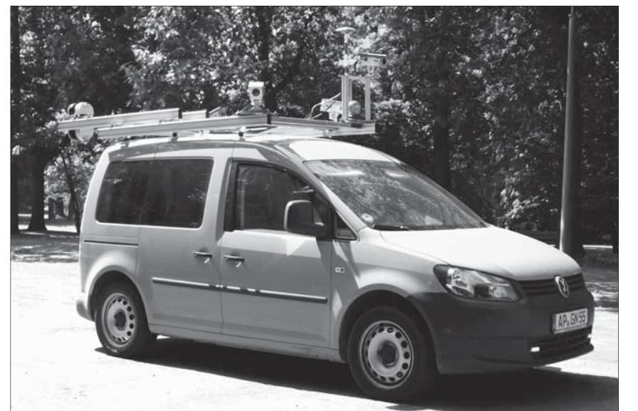
Messfahrzeug zur digitalen Straßenerfassung
